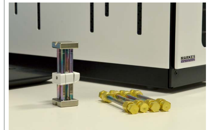
Conjuntos de tubos de dessorção térmica, utilizados para colheitas de amostras de respiração
