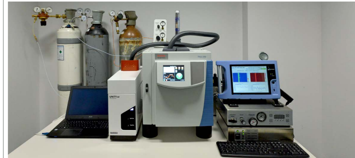
Sistema de biópsia respiratória, incluindo a unidade de dessorção térmica, cromatógrafo e detetor
