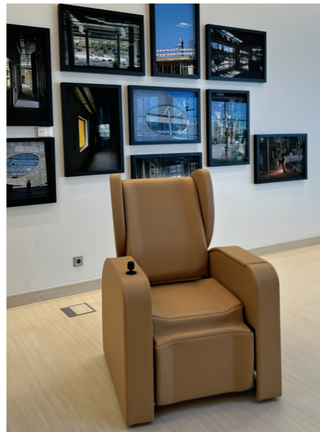
Cadeira de Quarto Robotizada. Solução de mobilidade hospitalar que permite ao doente manter a sua autonomia, mesmo depois de procedimentos cirúrgicos complexos. A cadeira move-se de forma omnidirecional, e configura-se para ajudar o doente a levantar-se e sentar-se. O projeto foi inteiramente desenvolvido na Fundação Champalimaud pela Plataforma de Hardware.
