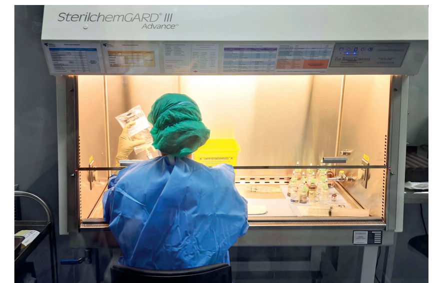
Farmácia – Preparação de tratamentos de quimioterapia na câmara de fluxo laminar vertical.
